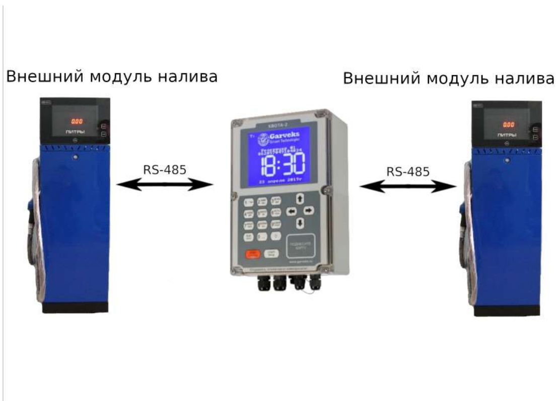
Рисунок 5: Конфігурація з зовнішніми модулями налива, два поста
