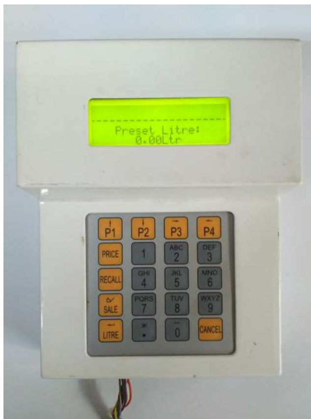
Рисунок 16: Пульт для настройки колонки Sanki
