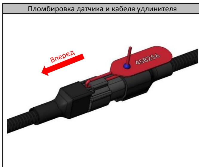
Пломбировка головы датчика осуществляется установкой защитной крышки и продеванием пломбы через общие отверстия головы и крышки.
