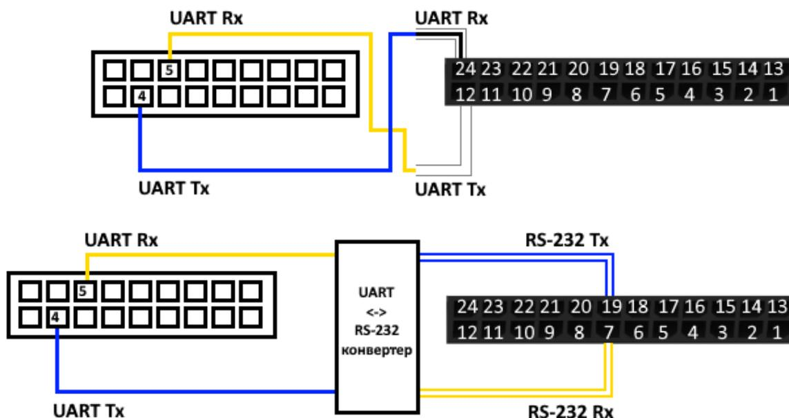
Continental VDO DTCO 3283/1381 подключается через интерфейс RS-232 – находится на передней панели тахографа. Для считывания информации по картам и тахографу необходимо также подключить CAN-шину автомобиля к тахографу и блоку мониторинга. Подключение CAN-шины опционально.
