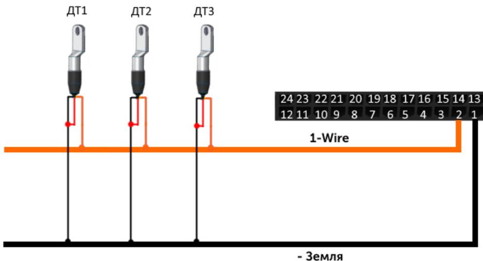
Чтобы блок распознал подключение нового датчика, необходимо подключиться к устройству через программу «Конфигуратор», зайти в меню «Настройки» -> вкладка «Входы/выходы» и выбрать пункт настроек «Внешние датчики температуры».
